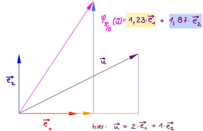
$$\text{mit } \begin{pmatrix} y_1 \\ y_2 \end{pmatrix} = A_\alpha \cdot \begin{pmatrix} x_1 \\ x_2 \end{pmatrix} = \begin{pmatrix} \cos(\alpha) & -\sin(\alpha) \\ \sin(\alpha) & \cos(\alpha) \end{pmatrix} \cdot \begin{pmatrix} x_1 \\ x_2 \end{pmatrix}$$
