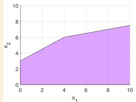
$$(LP_2) \begin{cases} \text{maximiere } F(\vec{x}) = \vec{c}^T \vec{x} \\ \text{und.N. } \begin{pmatrix} -3 & 4 \\ -1 & 4 \end{pmatrix} \vec{x} \leq \begin{pmatrix} 12 \\ 20 \end{pmatrix} \\ \vec{x} \geq \vec{0} \end{cases}$$
